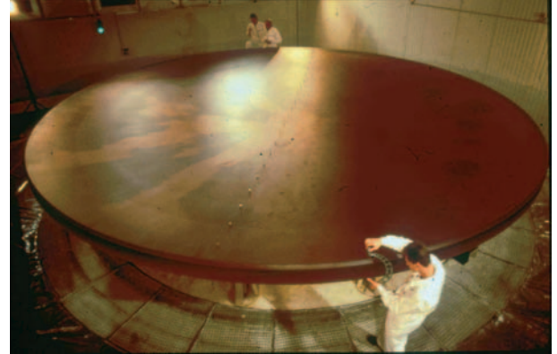
Abb. 3: Einer der vier 8,2-m-Spiegelträger für das Very Large Telescope der Europäischen Südsternwarte, gefertigt aus einer Glaskeramik.
